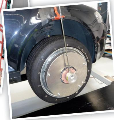
Messreifen eines Testfahrzeuges
